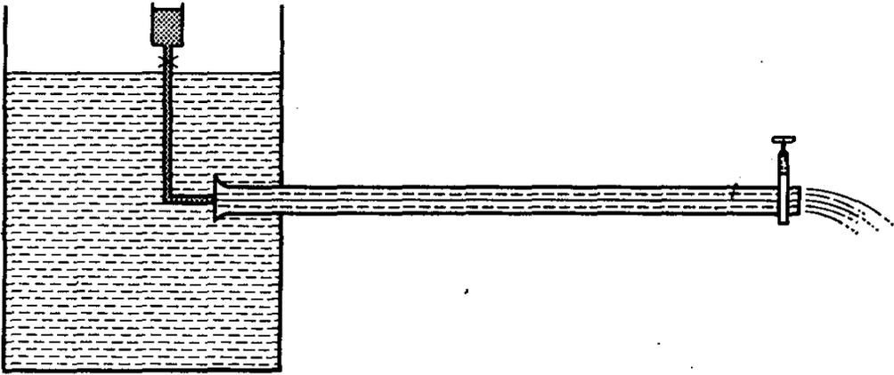
FIG. 5.12. Reynolds apparatus.
