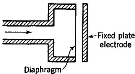
FIG. 9.4. Capacitance gage.
