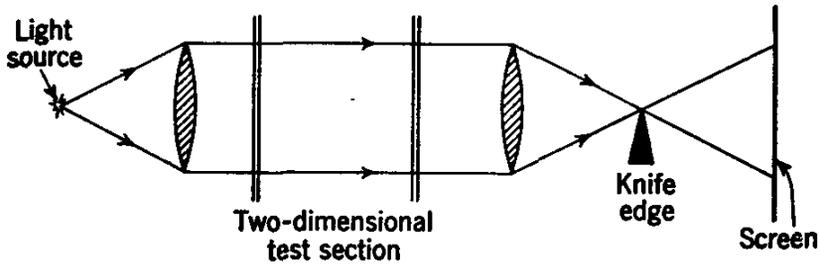
FIG. 9.13. Schlieren system.
