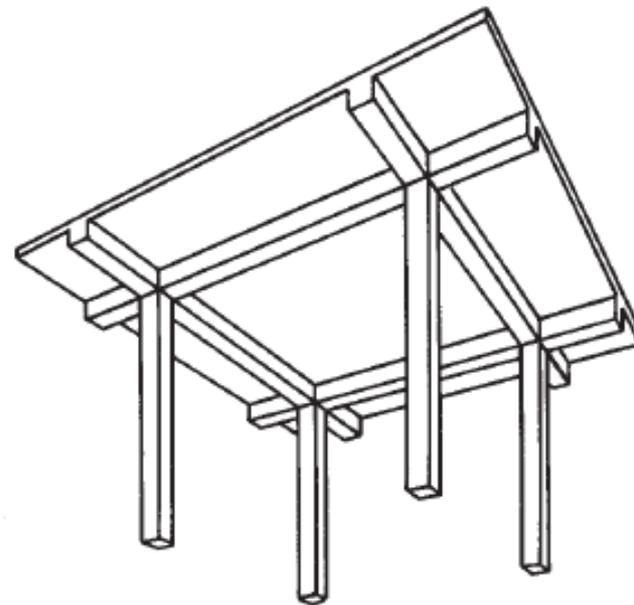
(d) Two-way slab with beams.
