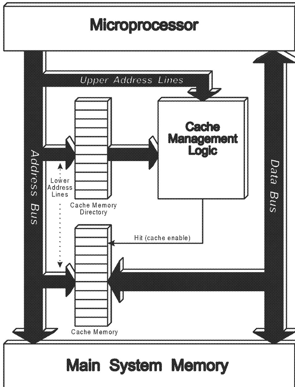
Figure 14-2. Cache Subsystem Components
