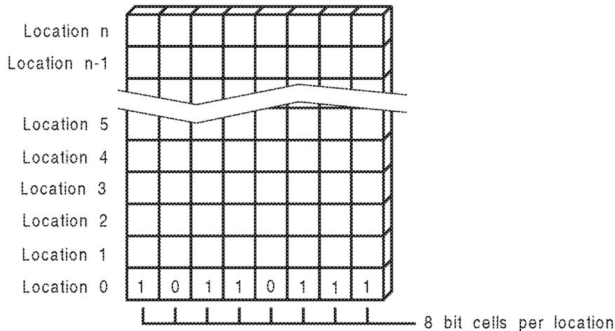
*Figure 15-1. The Bit Cell*
