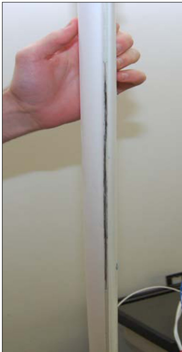
Figure 5 Edge Crack
