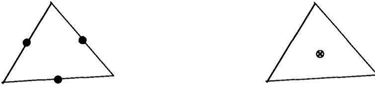
Fig. 5.9. The nonconforming  $P_1$  element.
