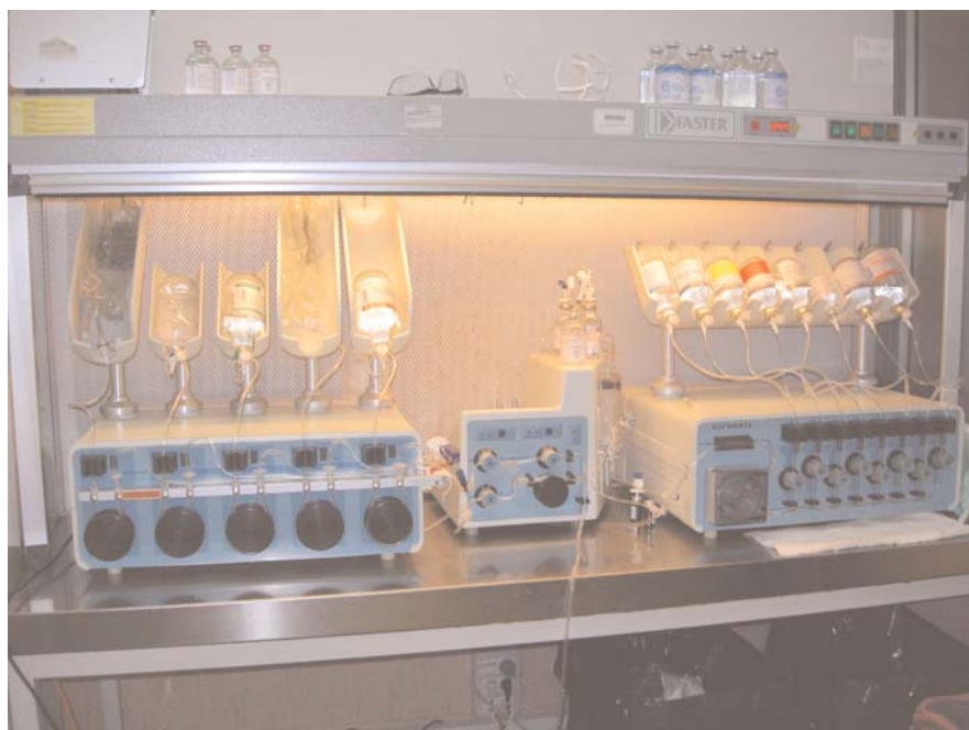
Fig. 5.5 Sistema automatizzato adatto per sacche pediatriche
