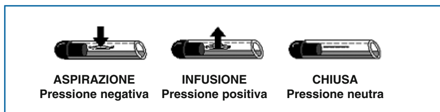
Fig. 2.2 CVC tipo Groshong® della Bard Access System, Inc. (Salt Lake City, Utah, USA)
