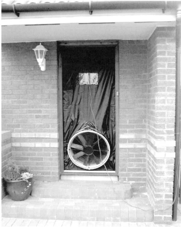
Figure 5.3 Blow door fan rig.
