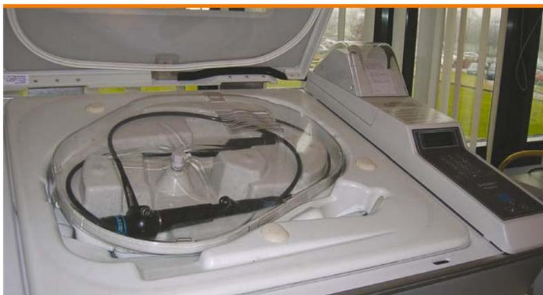
Fig. 9. Macchina sterilizzatrice ad acido peracetico Steris System 1
