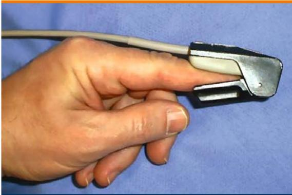
**Fig. 1.** Il rilevatore del pulsossimetro ha una forma a pinza, viene posto a cavallo del polpastrello di un dito della mano (o del lobo dell'orecchio), una valva ha l'emittente di luce, quella opposta il rilevatore
