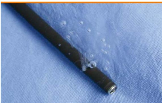
**Fig. 6.** Il test di tenuta evidenzia la fuoriuscita di bollicine all'estremità distale del fibrobroncoscopio; la piccola lesione non era evidenziabile all'ispezione dello strumento
