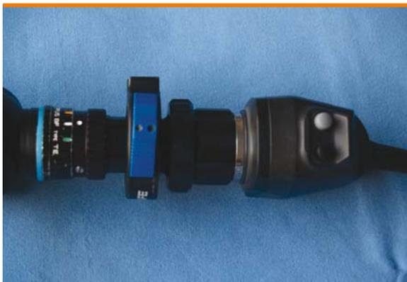
**Fig. 3.** Oculare con telecamera innestata
