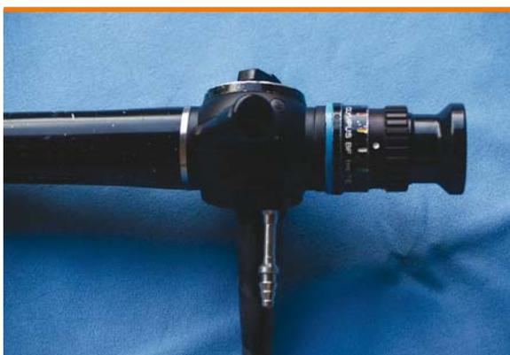
**Fig. 4.** Oculare e sistema d'aspirazione
