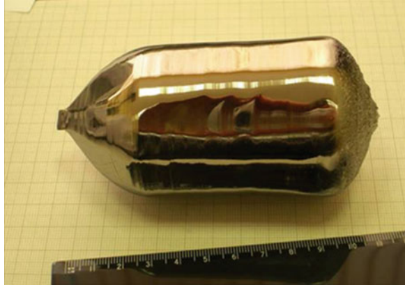
Fig. 29.1 InSb ingot ( \varnothing 2' )
