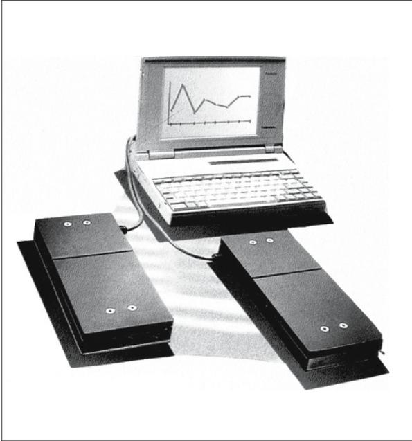
**Fig. 9.10** Pedana Tetrax: è costituita da due pedanine, una per piede, ciascuna delle quali è composta da due semipedanine in modo da poter rilevare in modo indipendente le oscillazioni del CoP della punta e del tallone del piede destro e del piede sinistro
