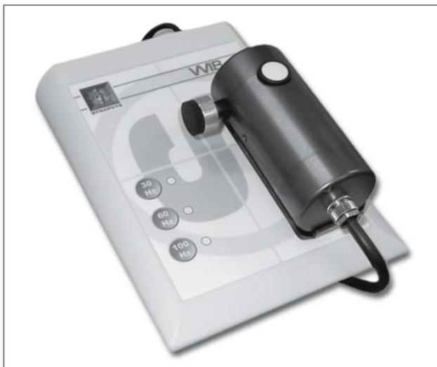
Fig. 7.3 Synapsys - VNG Ulmer. Strumentazione per la valutazione vestibolare e la riabilitazione dell'equilibrio (Per gentile concessione di Synapsys S.A.)
