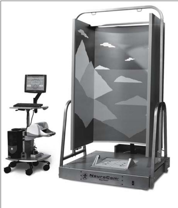
**Fig. 9.11** Pedana stabilometrica dinamica Equi-Test®: è costituita da una pedana, che può trasalire e inclinarsi, e da una cabina che rappresenta l'ambiente visivo. La cabina può inclinarsi (Per gentile concessione di NeuroCom International, Inc.)
