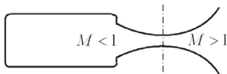
Fig. 7.3. A de Laval rocket nozzle
