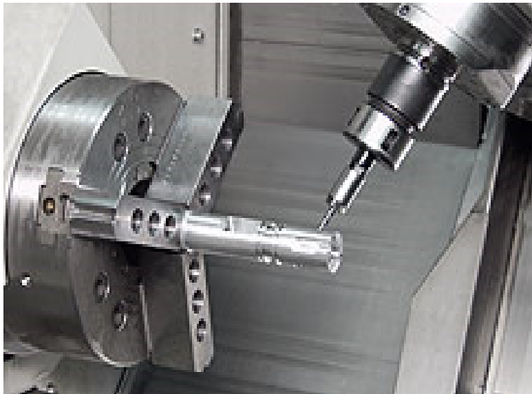
Fig. 5. CNC mill-turn center
