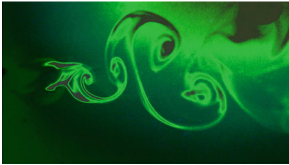
Fig. 4 Picture showing the inverse Bénard-von Kármán wake
