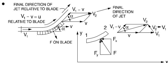
$$-F_x = Q\rho(V_{2x} - V_{1x})$$
