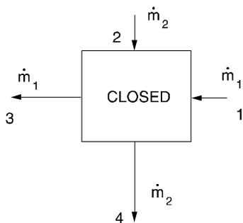
$$\dot{m}_1 h_1 + \dot{m}_2 h_2 = \dot{m}_1 h_3 + \dot{m}_2 h_4$$
