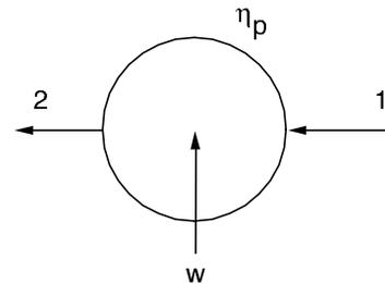
$$w = h_1 - h_2 = (h_1 - h_{2s}) / \eta_p$$
