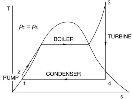
$\eta = \frac{(h_3 - h_4) - (h_2 - h_1)}{h_3 - h_2}$
