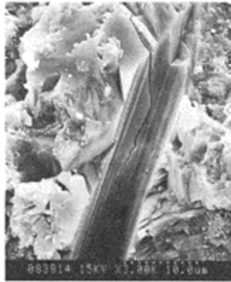
Fig. 18. Empreinte d'une fibre de carbone dans la matrice . 90 jours d'hydratation.
