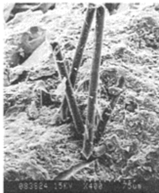
Fig. 19. Fibre de polyaramide. 90 jours d'hydratation.
