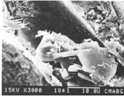
Figure 6. Absence de fibre après 360 jours d'hydratation dans la matrice de CPA.
