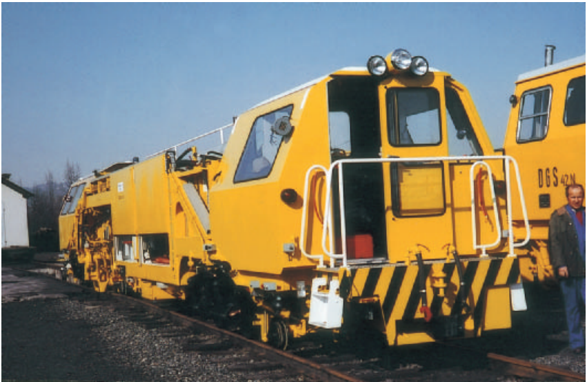
Fig. 3.13. Ballast tamping machine.
