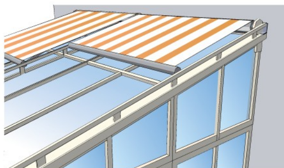
Figure 14 : Protection solaire extérieure par store
