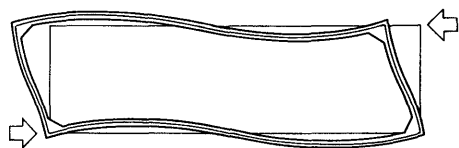
Deformación bajo carga horizontal
